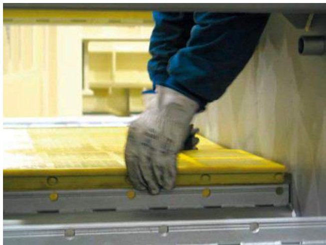
Fixation de panneau avec des tétons.
