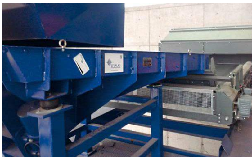
Alimentateur vibrant à séparateur à courants de Foucault
